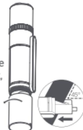
⚠ Pre ľahšie rezanie by mal rezač a bezpečnostný pás zvierať uhol 45 °.
